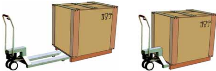
Fig. 13: La vagoneta elevadora debe introducirse completamente debajo del caballete de transporte
