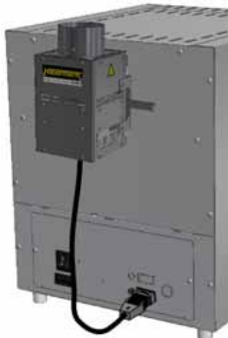
Chimenea de salida con ventilador para extraer mejor del horno los gases de escape que se originan. Con los controladores B400 - P480 se pueden activar el ventilador de forma automática (no en el modelo L(T) 15., L 1/12, LE 1/11, LE 2/11).*
