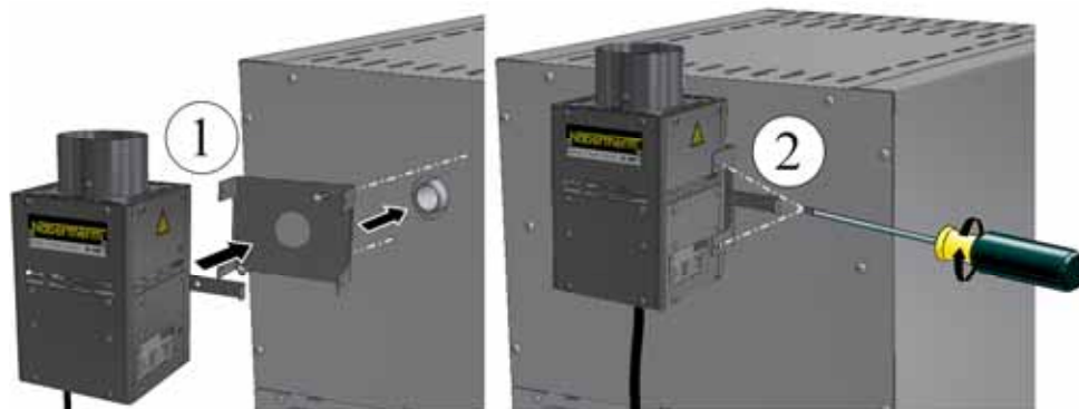
Fig. 16: Chimenea extractora con ventilador
